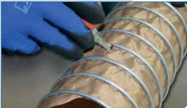
Zum Schluss schneiden Sie die Schlauchwandung sauber entlang des Klemmprofils ab.
