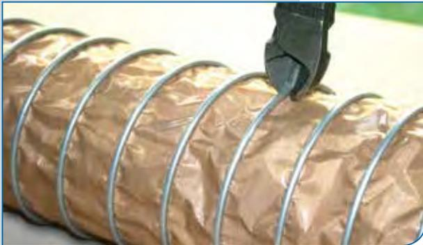
Schneiden Sie die Schlauchwandung bis zu den beiden benachbarten Profilwendeln mit einem scharfen Messer auf.
