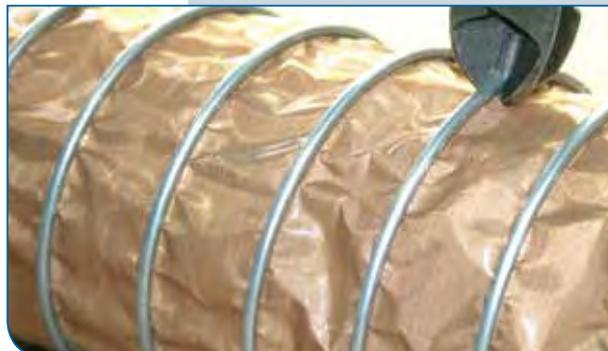
Ziehen Sie die beiden Schlauchenden auseinander und durchtrennen Sie zunächst die Stützwendel mittels Seitenschneider.
