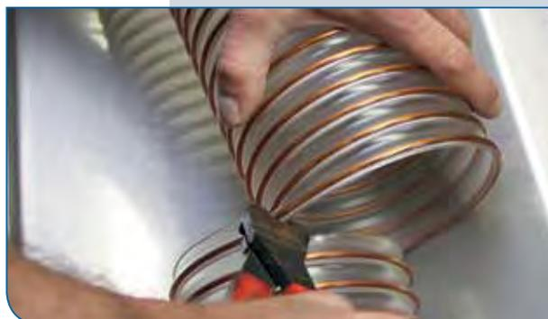
Zum Schluss schneiden Sie die Schlauchwandung sauber entlang der Stützwendel ab.
