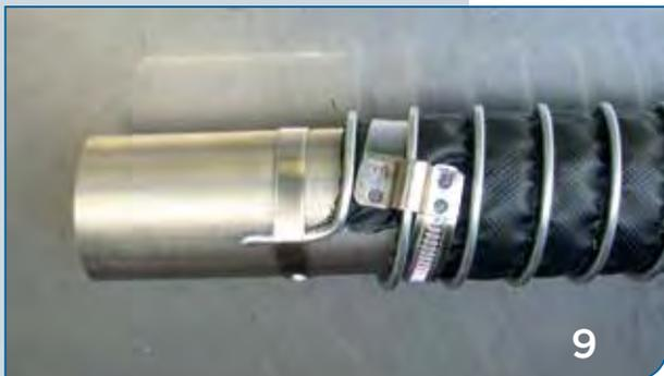
Bringen Sie nun die Drahtbefestigungsschelle an. Ziehen Sie beide Schellen so fest an, dass das freigelegte Metall-Klemm-Profil fest auf das Rohr gepresst wird und der Schlauch fixiert ist. Kontakt zwischen Metall-Klemm-Profil und Rohr muss vorhanden sein.
